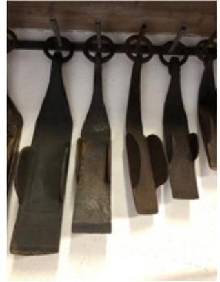
*Freins-sabot de roues à cercle utilisées pour les chars tirés par les chevaux jusqu'à la moitié du siècle dernier*
