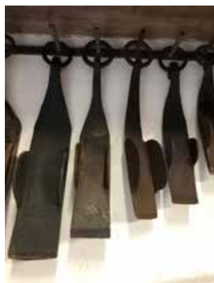
Freins-sabot de roues à cercle utilisées pour les chars tirés par les chevaux jusqu'à la moitié du siècle dernier
